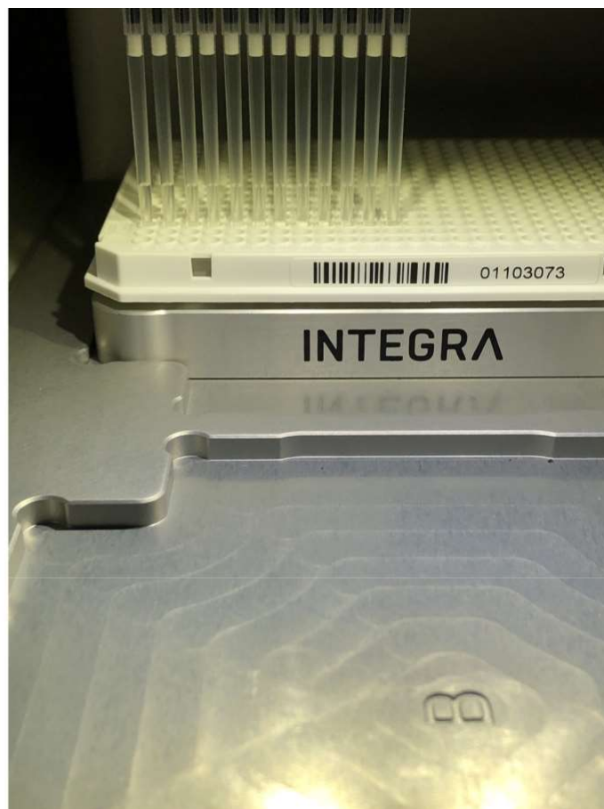
Рисунок 2: Точное и аккуратное дозирование реагента Mastermix для одностадийной ОТ-ПЦР из резервуара для реагентов с малым мертвым объемом в планшет с 384 лунками.
